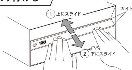
最初にお名前を記入した透明シートをガイドに押し当て、表面を指で軽く押しながら、ガイドの上の溝(上図参照)に透明シートが入るように上にスライドさせます。続いて、透明シートを押し当てたまま下にスライドさせ、セットします。次に部屋番号が記入された透明シートも同様の方法でガイドにセットしてください。
