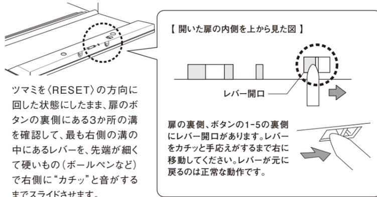
ボタンがすべてとび出している状態でツマミがOPEN方向に回れば暗証番号が設定されていない状態です。
