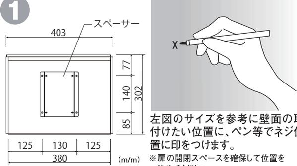
左図のサイズを参考に壁面の取付けたい位置に、ペン等でネジ位置に印をつけます。
