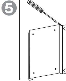
スペースを壁面に木ネジでねじ込み固定します。
