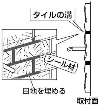
[2] 取付面(パッキンまたは木台外径)から内側に約1cmの幅でシール材を塗る
