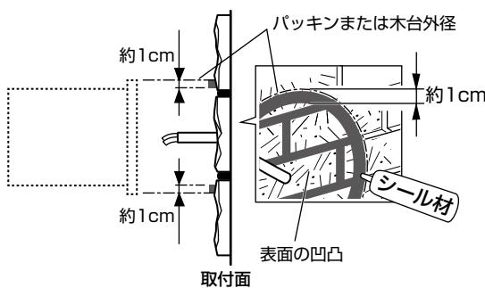
⚠️ 警告 防水処理が不完全な場合、感電・火災・器具破損の原因になります。
