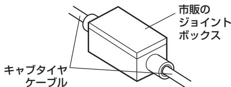
⚠️ 注意 キャブタイヤケーブルをコンクリートや土で埋めないでください。ケーブルが破損し、
