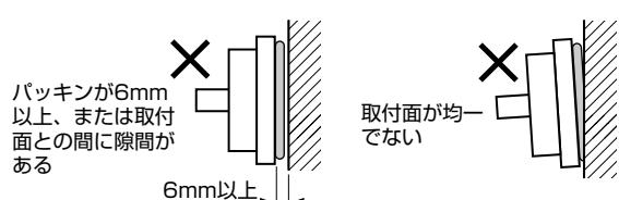
上記を守らないとパッキンが取付面に密着せず、浸水による感電、火災、器具破損の原因になります。
