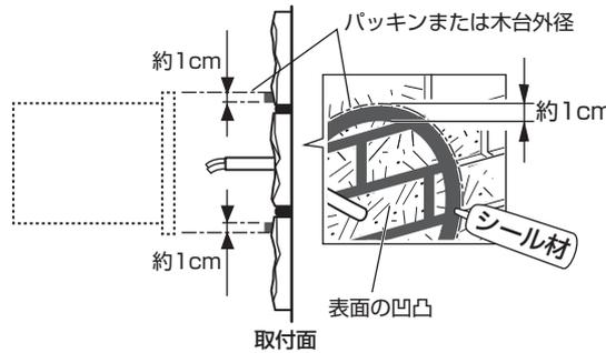
**警告** 防水処理が不完全な場合、感電・火災・器具破損の原因になります。
