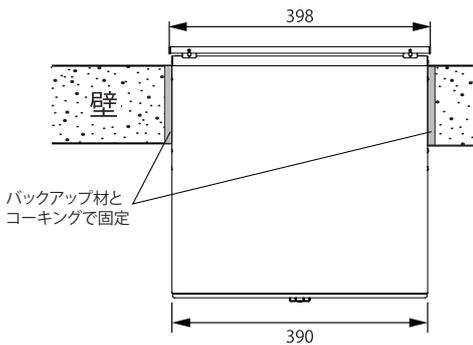
【図6】施工時 (側面図)
