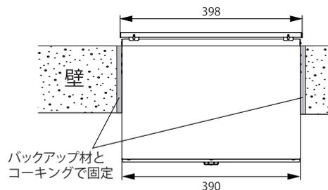
【図 3】施工時(側面図)
