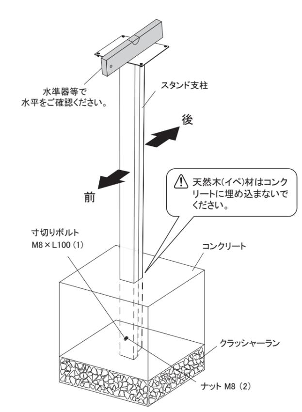
③ ポストを支柱プレート(または支柱ブラケット)の上のせ、スリムヘッド小ネジとフランジナットで固定します。
