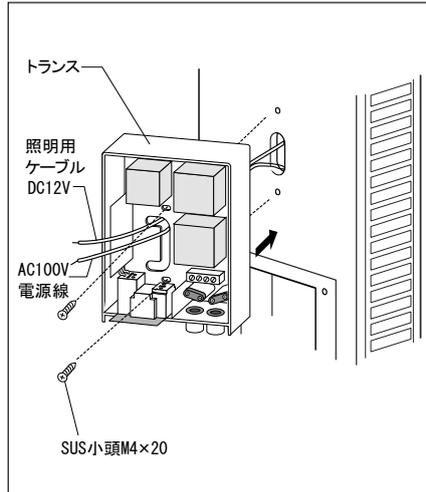
②AC100V電源線、照明ケーブルをトランス背面より、トランス内部へ入れて下さい。
