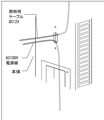
①AC100V電源線、照明ケーブルを本体の穴より取り出して下さい。
