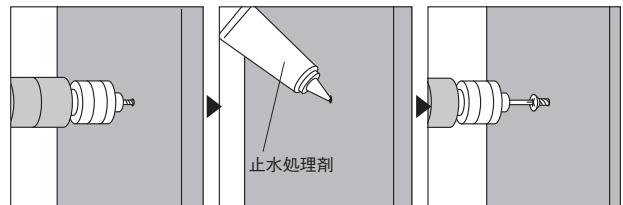
例) M4ネジを使用する場合 下穴φ3.6
