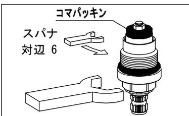
⚠ 交換が終わったスピンドル部を本体に締め込み、ハンドルを仮付けしたときにハンドルが開いた状態になっているのを確認してください。閉じた状態だとスピンドル部の締め込みが弱く、水もれの原因になります。ハンドルを全開にして、もう一度スピンドル部を締め込んでください。
