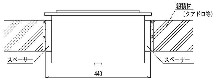
[ 幅450ミリサイズの組積材に設置する場合 ]
