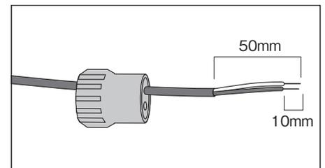
③エコルトケーブルNのシースを50mm剥き、銅線の被覆を約10mm剥いてください。
