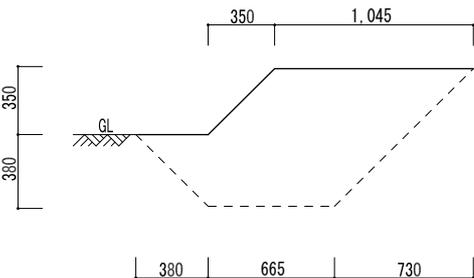
※参考根切り断面図 1.土質及び現場の状況により、断面図が異なりますので、ご注意ください。また、余掘りは見込んでいませんのでご注意ください。2.根切りにより掘り出した土は、土質によりボリュームが増加する場合があります。残土処理の数量については、現場状況に合わせて調整して下さい。
