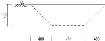
■ 土留め GLより高さ350(基礎より5段積み、ポーター含む)
