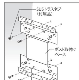
②ポスト取り付けベースを門柱にSUSTラスネジM4で取り付けます。
