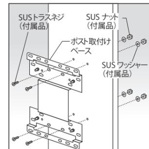
②ポスト取り付けベースを門柱にSUSTラスネジM4、SUSナットM4、SUSワッシャー M4を使って取り付けます。
