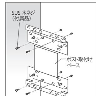
②ポスト取り付けベースを門柱にSUS木ネジで取り付けます。
