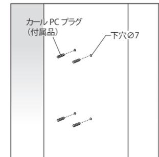
①門柱にφ7mmの下穴を設け、付属品のカールPCプラグを差し込みます。
