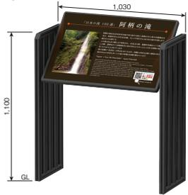
[材質]支柱:アルミ(押出形材、塗装仕上げ)
