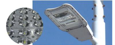
道路照明に用いられる光学レンズを活用し、ソーラー照明用に専用設計された新型LED灯具です。横方向への広がりを持たせた配光特性により防犯灯の照度基準クラスA、クラスB+に対応しています。
