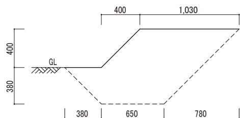
※参考根切り断面図 1.土質及び現場の状況により 断面図が異なりますので、ご注意下さい。また、余掘りは見込んでいませんのでご留意下さい。2.根切りにより掘り出した土は、土質によりボリュームが増加する場合があります。残土処理の数量については、現場状況に合わせて調整をして下さい。
